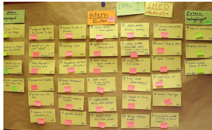
SMED Stufe 1: Betrachtung der Prozessschritte für internes und externes Rüsten
