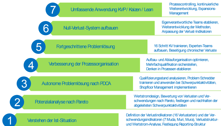
Abb. 2: Die sieben Schritte der Säule "Lean Management und fokussierte Verbesserung".
