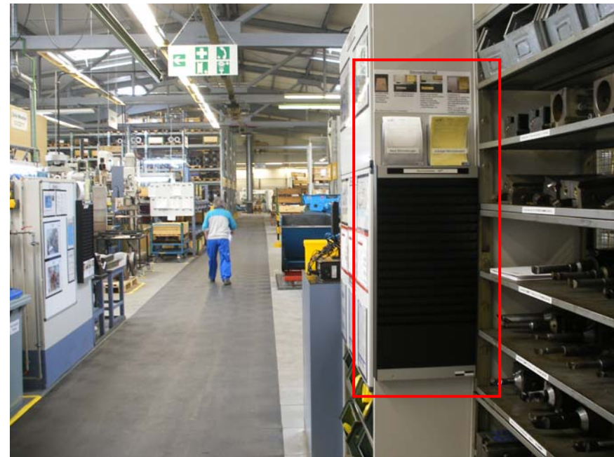
Störmeldetafel am Gang beim Zugang zur Zelle SMT angebracht
