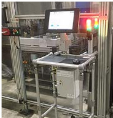
Das Andon-Signal zeigt den Betriebszustand.
