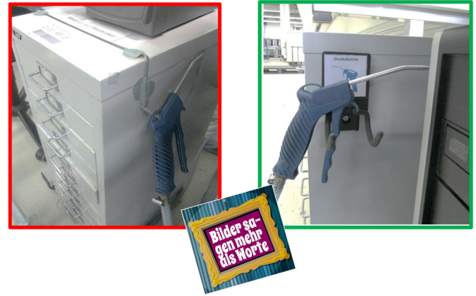
Ruck-Zuck verbessert: Eine neue Halterung für die Pressluftpistole.
