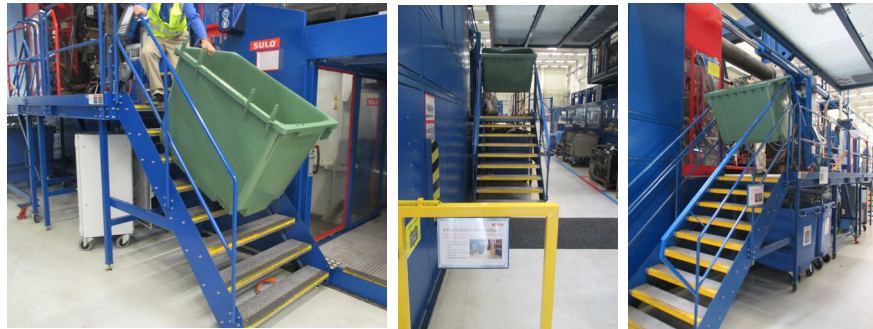
Vorher: Die Behälter rutschten die Treppe hinunter (links). Nachher: Kontrolliertes Handling durch Behälterrutsche.
