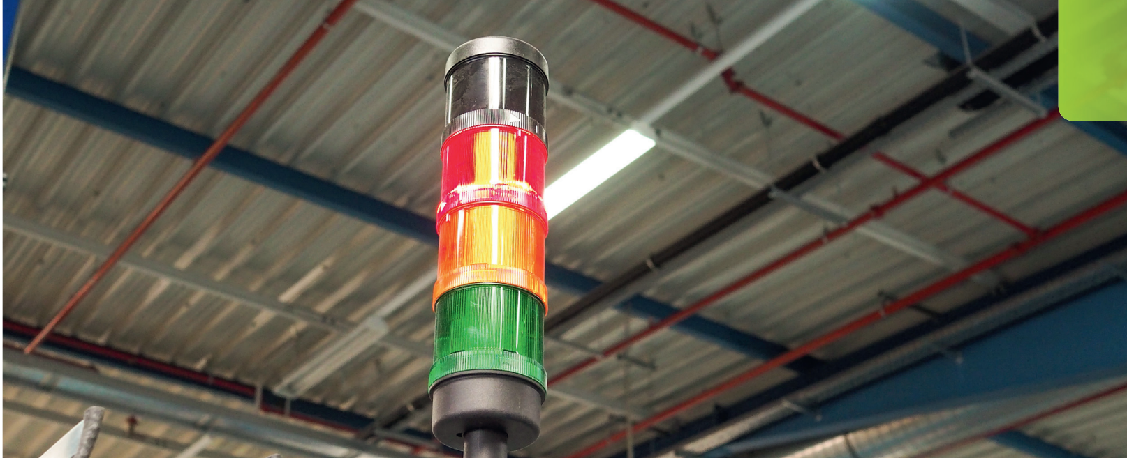
Abb. 1: Das Andon-Licht signalisiert, wenn es Probleme vor Ort gibt. So kann der Teamleiter schnell reagieren.
