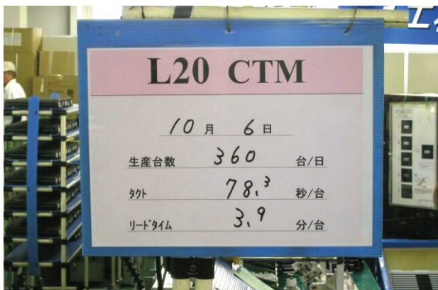
Für alle sichtbar sind hier die Tages-Sollwerte einer Linie: Stückzahl, Taktzeit und Durchlaufzeit
