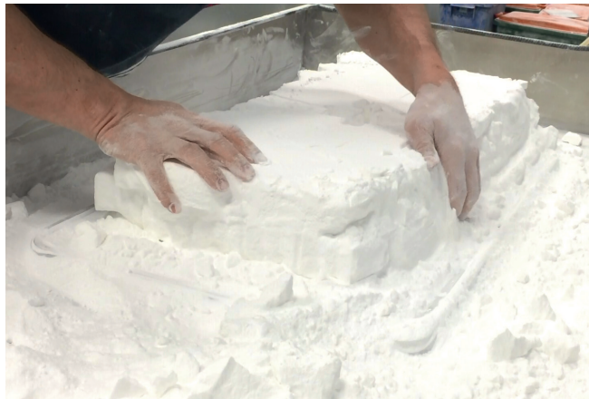
Abb. 4: Das fertige Bauteil wird aus dem Pulverbett ausgepackt. Pulverreste werden abgesaugt und können wiederverwendet werden.
