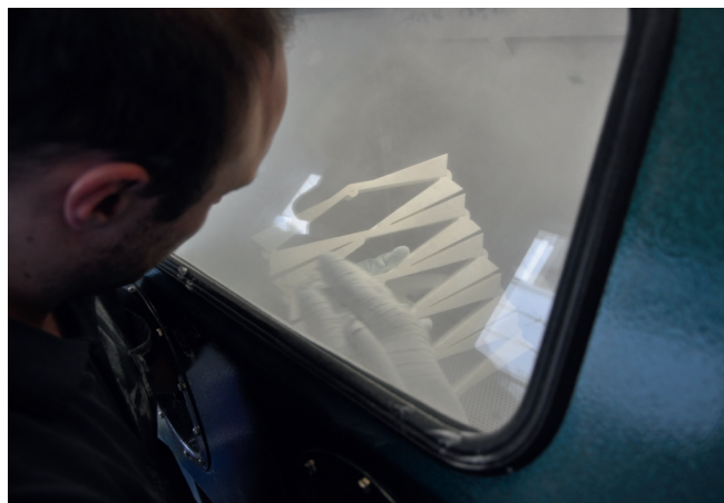
Abb. 5: Der Leuchtenkörper ist sofort funktionsfähig und damit auf 1,4 m vergrößerbar. Er wird von Hand und per Druckluft vom Pulver gereinigt.
