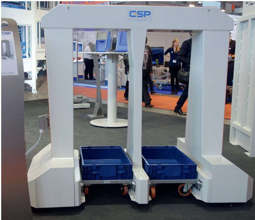
Abb. 2: Die Bodenroller werden in den Anhängerbogen geschoben und anschließend auf Knopfdruck per automatischer Hubeinrichtung angehoben. So sind sie vor übermäßigem Verschleiß geschützt und die Sicherheit beim Transport ist gewährleistet.
