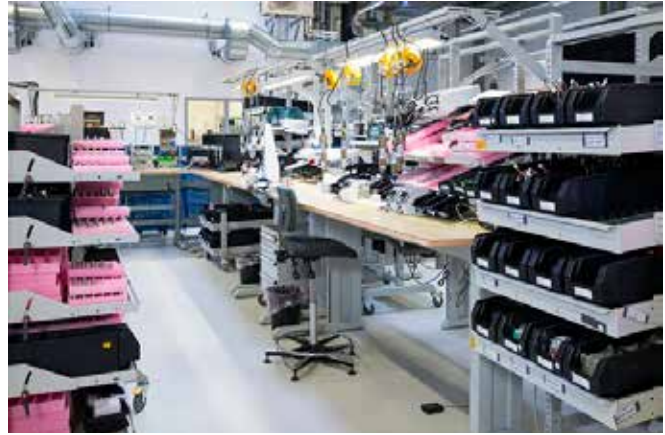
One-Piece-Flow: Ein Werkstück wird in einer Insel bis zur Fertigstellung bearbeitet.
