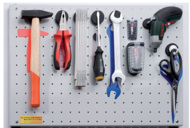
Ein Standard zur Reduzierung von Suchzeiten: Das Shadowboard sorgt für Ordnung. Hier eine Ausführung mit Magnetfolie. Bezugsquelle: www.schallenkammer.de
