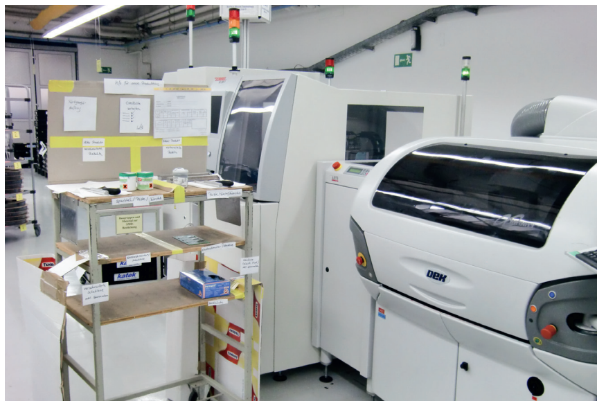
Abb. 4: Erarbeitet während der SMED (Single minute exchange of die) -Workshops: Ein Werkzeugregal an der SMT Linie, alles hat seinen Platz, alles ist an seinem Platz - das ist das Motto von 5S. Die interne Rüstzeit am SMT-Schablonendrucker wurde von Lean Manager Paul Altmann mit seinem Team von 10 Minuten auf 3 Minuten reduziert
