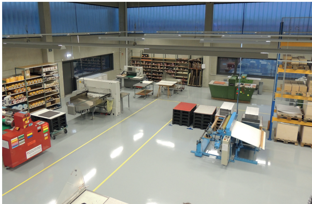
Abb. 3: Die U-förmige Anordnung der Maschinen spart Zeit und Wege und schafft Transparenz
