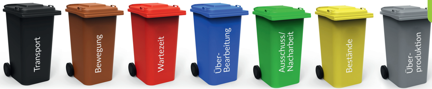
Abb. 1: Die klassischen "Sieben Arten der Verschwendung". Quelle: Fotolia (c) Thomas Söllner, Grafik wurde bearbeitet.
