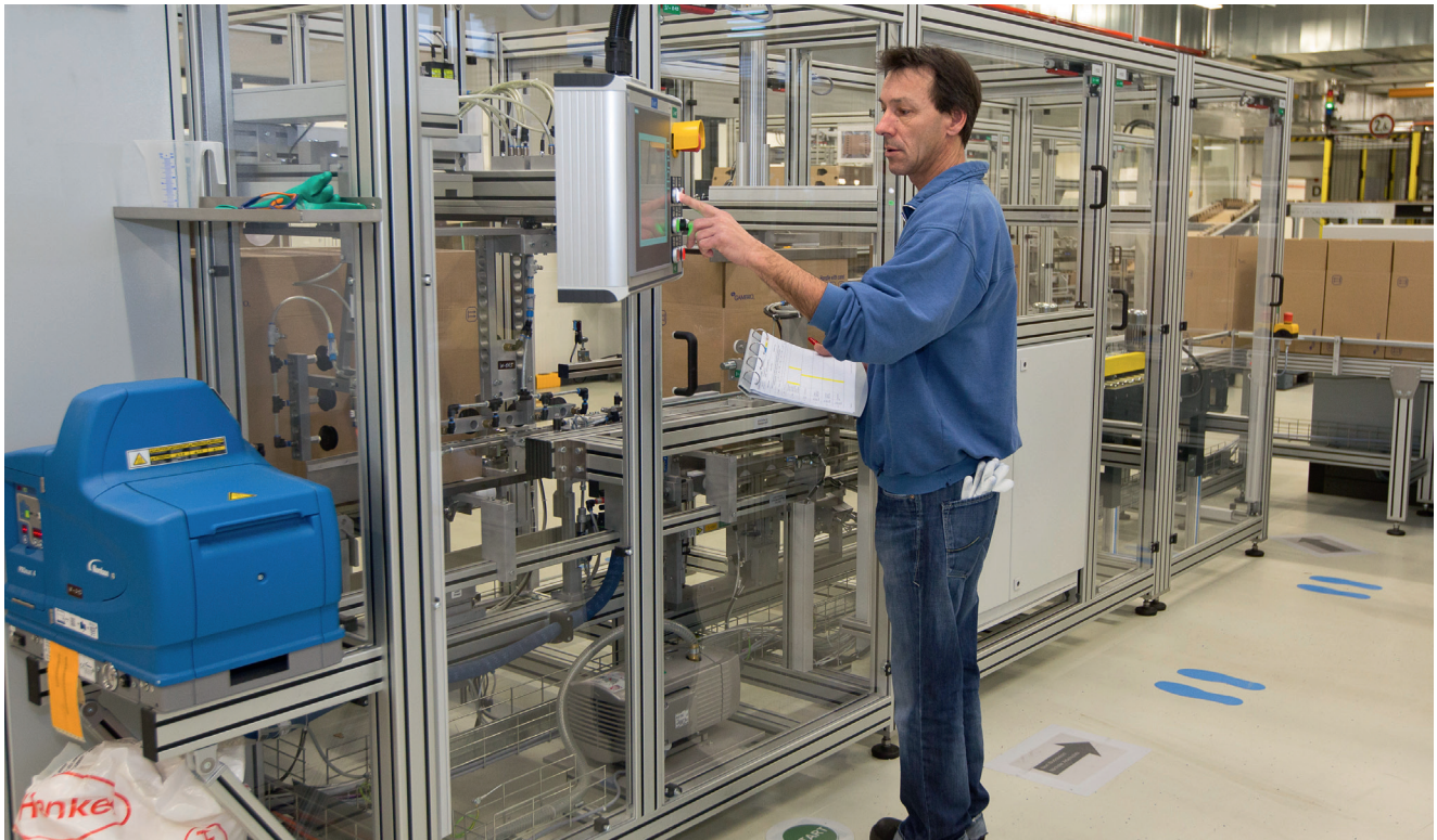
Abb. 2: Auf den Standpunkt kommt es an: Seit der Einführung von TPM werden nur noch transparente Maschinen installiert und der optimale Standpunkt für Wartungsarbeiten ist mit Footprints markiert.
