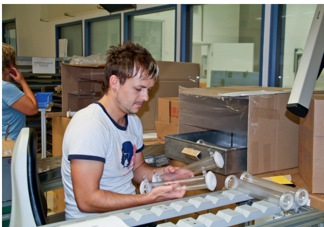
Abb. 1: Frühzeitige Optimierung von Ergonomie und Arbeitsabläufen durch Simulation am Kartonmodell: Im Team werden Verbesserungen erarbeitet.
