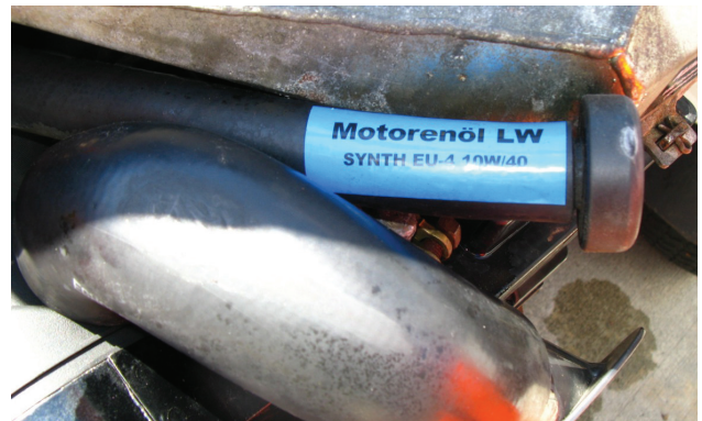
Eine klare Kennzeichnung vereinfacht die Wartung der Geräte. Nachfragen entfallen, jeder kann mitanpacken
