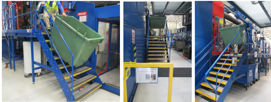
Vorher: Die Behälter rutschten die Treppe hinunter (links). Nachher: Kontrolliertes Handling durch Behälterrutsche.
