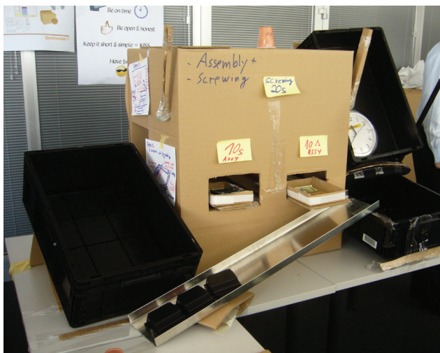
Lernen durch Tun: Rutsche zur Nutzung der Schwerkraft wird an Kartonsimulation getestet
