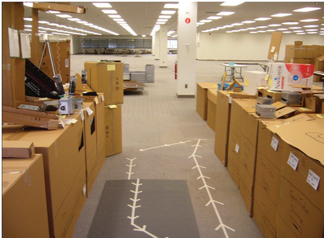
Planung einer neuen Linie: Mit Kartonsimulation lassen sich viele Optionen testen und beurteilen
