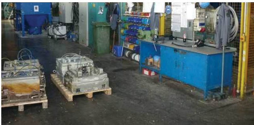
Selbst an Arbeitsplätzen wie hier beim Werkzeugwechsel (links) konnte durch Einsatz eines Rüstwages (rechts) Fläche eingespart werden. Gleichzeitig wird nun durch mehr Transparenz effizienter gearbeitet.
