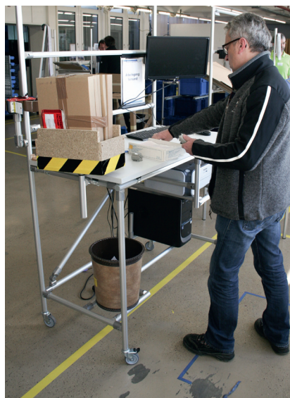
Ob mit Rückwand und Rädern (links) oder als einfacher Aufbau: Mit dem item Lean Production System D 30 lassen sich im Handumdrehen Ablagen, Workstations oder Montageplätze maßgeschneidert zusammenbauen. Das gefällt den angehenden Lean Production Masters.
