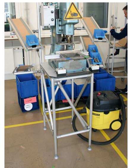
Ob mit Rückwand und Rädern (links) oder als einfacher Aufbau: Mit dem item Lean Production System D 30 lassen sich im Handumdrehen Ablagen, Workstations oder Montageplätze maßgeschneidert zusammenbauen. Das gefällt den angehenden Lean Production Masters.
