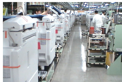
"Was ist notwendig und nützlich für den, der etwas baut?" Das ist die Kernfrage, die im Vordergrund stehen sollte. Beispiel: Seit 1999 verzichtet Ricoh auf elektrisch angetriebene Fließbänder und baut in "layout-free factories", um auf die ständig wechselnde Nachfrage und Modellvielfalt reagieren zu können. Fotos: RICOH Company Ltd.
