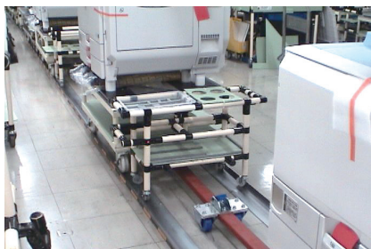
"Was ist notwendig und nützlich für den, der etwas baut?" Das ist die Kernfrage, die im Vordergrund stehen sollte. Beispiel: Seit 1999 verzichtet Ricoh auf elektrisch angetriebene Fließbänder und baut in "layout-free factories", um auf die ständig wechselnde Nachfrage und Modellvielfalt reagieren zu können. Fotos: RICOH Company Ltd.
