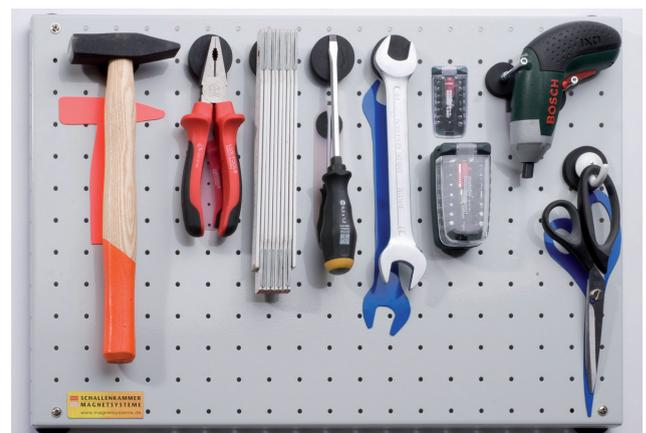
Ein Standard zur Reduzierung von Suchzeiten: Das Shadowboard sorgt für Ordnung. Hier eine Ausführung mit Magnetfolie. Bezugsquelle: [www.schallenkammer.de](http://www.schallenkammer.de)
