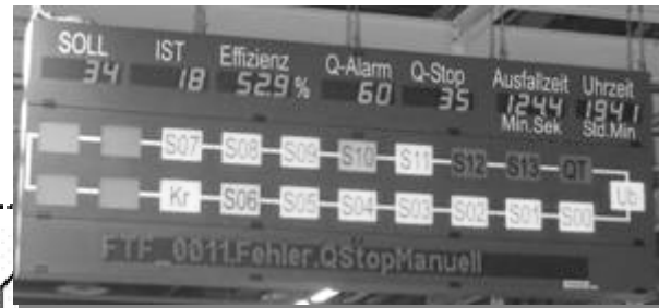
Montagelayout als geschlossener Loop
