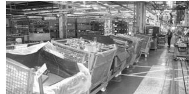
Nachher: 2-Behälter Kanban an der Linie
